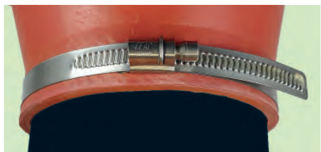
4 pipes Spannband 20 mm breit in V4A für Rohrgrößen DA 75 bis 280 mm , Anzugsdrehmoment 10 Nm
