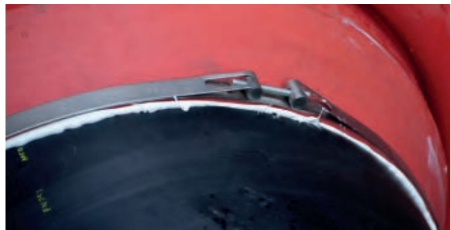
4 pipes Gelenkbolzenband ab DA 315 mm Anzugsdrehmoment 10 Nm
