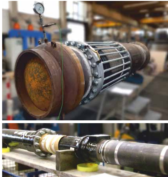
Abb. 2: Kompensator DN1000 / PN84 bei der Vorbereitung für die hydrostatische Festigkeitsprüfung im Werk
