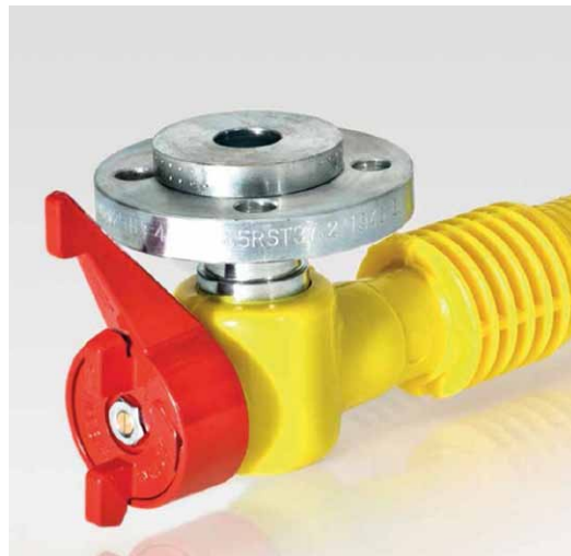
Abb. 1: Der Firesafe Griff schließt automatisch im Brandfall und verhindert sicher und zuverlässig das Austreten von Gas.
