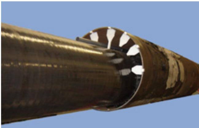
Kunststoffhalter mit angeformtem Clip an der Innenwand des Montagerohres befestigen, gegebenenfalls auf Länge zuschneiden. Der Abstand ist passend zu den Aussparungen in den Stützsegmenten zu wählen.
